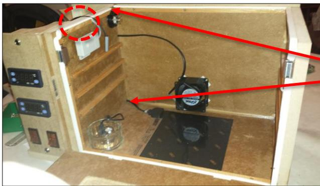
Passage des câbles dans la cloison :
